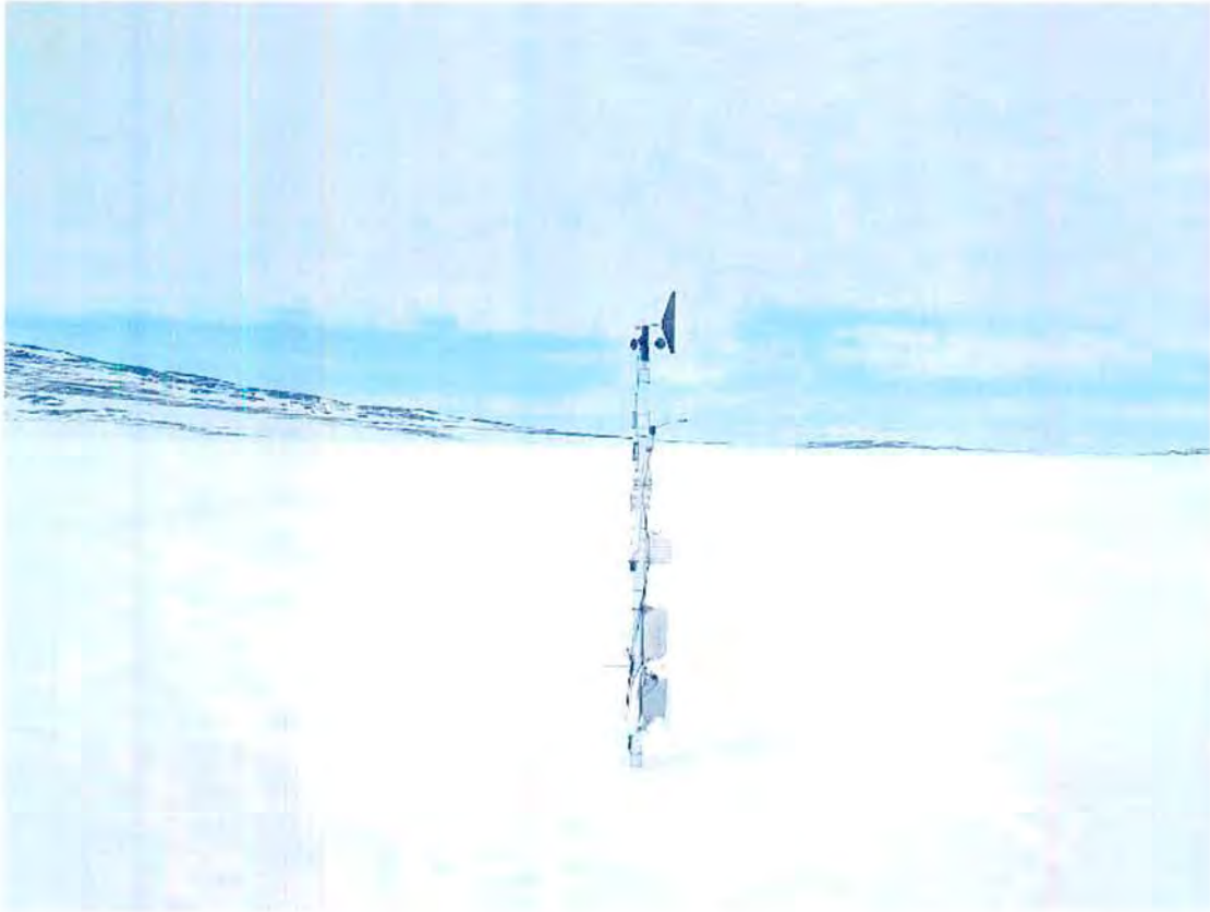
Figure 18 : Deux stations de suivi de glace de mer ont été installées dans les communautés d'Umiujaq et d'Akulivik le long de la baie d'Hudson pour les hivers 2007 et 2008. Ces stations enregistrent entre autres la température de l'air, l'humidité relative, la vitesse et la direction du vent et la radiation solaire (Photo : Eli Angiyou).
